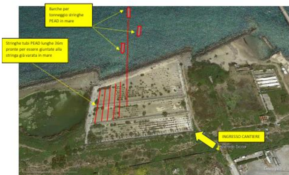
FIG. 6.04 CANTIERE A TERRA: ZONA ASSEMBLAMENTO E VARO STRINGHE IN MARE
