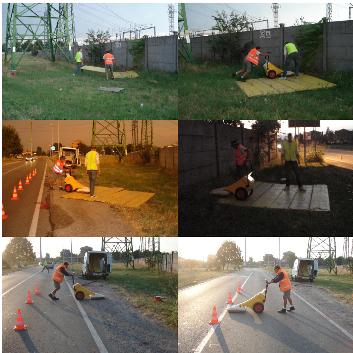
Figura 8 Rilievo georadar del 1 e 2 Settembre 2008. Si notino le tavole di legno necessarie alla movimentazione del georadar sul manto erboso.
