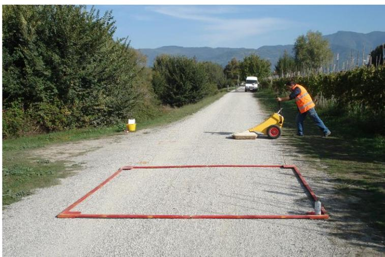
L'area interessata dal tracciato del progetto di massima di TERNA è stata esplorata con il georadar il giorno 17 Ottobre 2007. Sono stati rilevati N. 10 moduli di 3x3 metri (dal 67 al 76), per un totale di 90 mq. I moduli sono allineati in una stringa parallela all'asse della strada vicinale, che non è asfaltata ed è larga circa 3 metri. La lunghezza della stringa è pari a 30 m.
