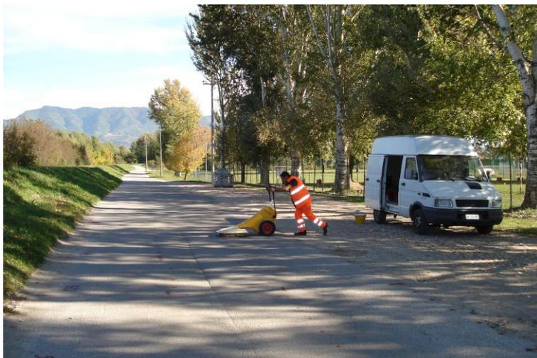
L'area interessata dal tracciato del progetto di massima di TERNA è stata esplorata con il georadar il giorno 19 Ottobre 2007. Sono stati rilevati N. 18 moduli di 3x3 metri (dal 223 al 240), per un totale di 162 mq. I moduli sono allineati in una stringa parallela all'asse della strada vicinale, che in questo tratto è asfaltata ed è larga circa 4,5 metri. La lunghezza della stringa rilevata è pari a 54 m.
