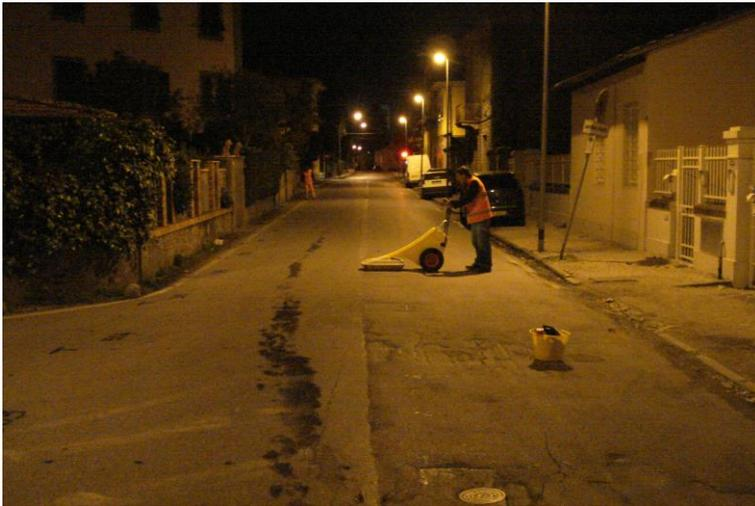
L'area interessata dal progetto di massima di TERNA è stata esplorata con il georadar la notte del 31 Ottobre 2007. Sono stati rilevati N. 36 moduli 3x3 metri (dal 500 al 535), per un totale di 324 mq. La stringa di moduli è allineata con il tracciato di massima del cavo e lo contiene, per una lunghezza totale di 108 m.
