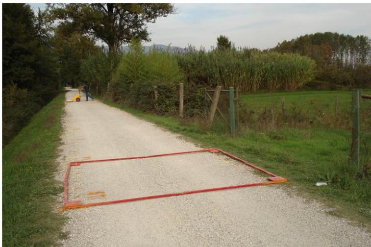
L'area interessata dal tracciato del progetto di massima di TERNA è stata esplorata con il georadar il giorno 17 Ottobre 2007. Sono stati rilevati N. 15 moduli di 3x3 metri (dal 131 al 145), per un totale di 135 mq. I moduli sono allineati in una stringa parallela all'asse della strada vicinale, che non è asfaltata ed è larga circa 3 metri. La lunghezza della stringa è pari a 45 m.
