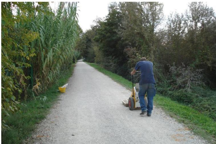
L'area interessata dal tracciato del progetto di massima di TERNA è stata esplorata con il georadar il giorno 17 Ottobre 2007. Sono stati rilevati N. 5 moduli di 3x3 metri (dal 146 al 150), per un totale di 45 mq. I moduli sono allineati in una stringa parallela all'asse della strada vicinale, che non è asfaltata ed è larga circa 3 metri. La lunghezza della stringa è pari a 15 m.
