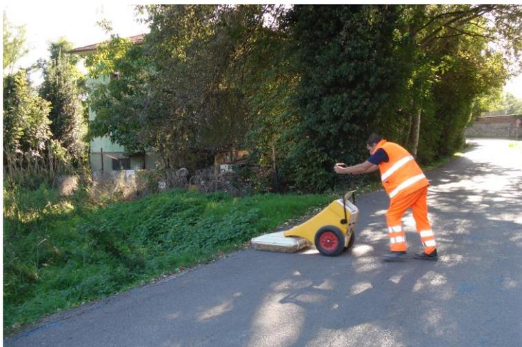
L'area interessata dal tracciato del progetto di massima di TERNA è stata esplorata con il georadar il giorno 19 Ottobre 2007. Sono stati rilevati N. 20 moduli di 3x3 metri (dal 271 al 290), per un totale di 180 mq. I moduli sono allineati in una stringa parallela all'asse della strada vicinale, che in questo tratto è asfaltata ed è larga circa 3 metri.
