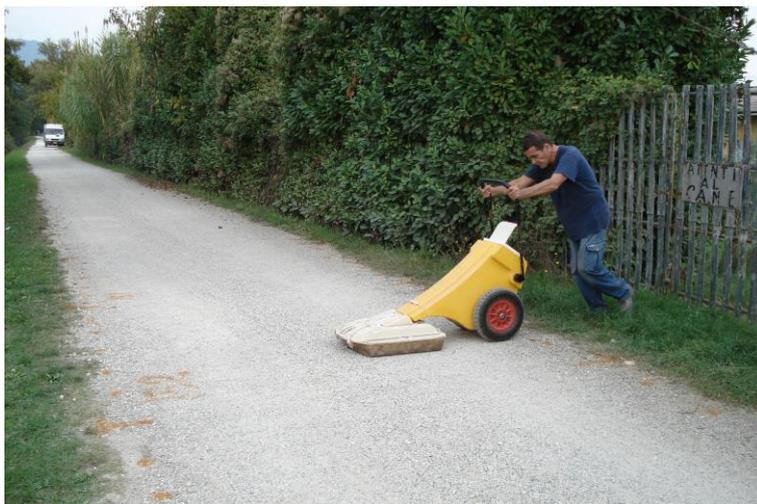
L'area interessata dal tracciato del progetto di massima di TERNA è stata esplorata con il georadar il giorno 17 Ottobre 2007. Sono stati rilevati N. 5 moduli di 3x3 metri (dal 151 al 155), per un totale di 45 mq. I moduli sono allineati in una stringa parallela all'asse della strada vicinale, che non è asfaltata ed è larga circa 3 metri. La lunghezza della stringa è pari a 15 m.
