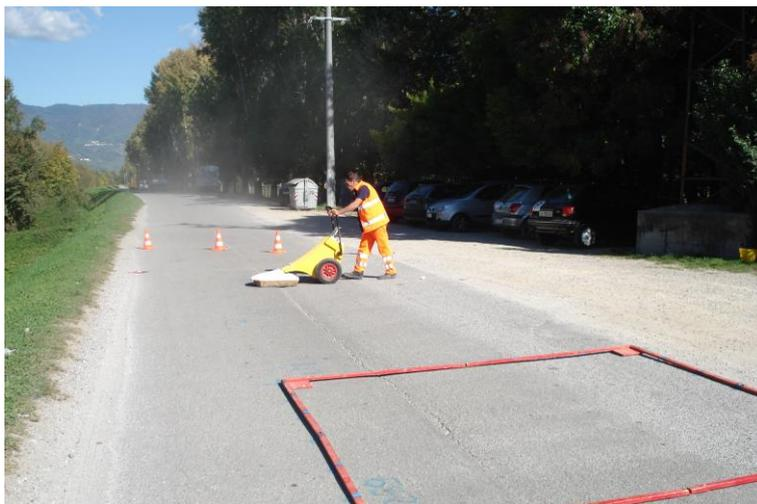
L'area interessata dal tracciato del progetto di massima di TERNA è stata esplorata con il georadar il giorno 19 Ottobre 2007. Sono stati rilevati N. 15 moduli di 3x3 metri (dal 256 al 270), per un totale di 135 mq. I moduli sono allineati in una stringa parallela all'asse della strada vicinale, che in questo tratto è asfaltata ed è larga circa 4 metri. La lunghezza della stringa rilevata è pari a 45 m.
