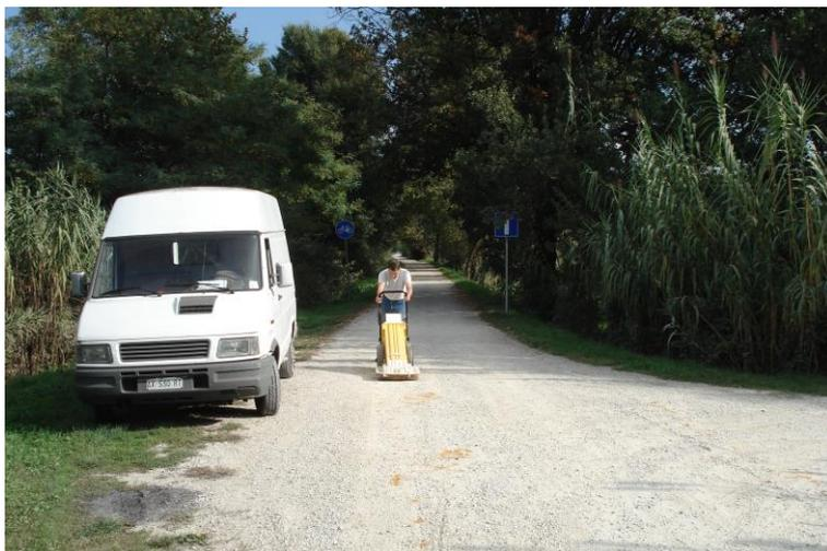
L'area interessata dal tracciato del progetto di massima di TERNA è stata esplorata con il georadar il giorno 18 Ottobre 2007. Sono stati rilevati N. 13 moduli di 3x3 metri (dal 171 al 183), per un totale di 117 mq. I moduli sono allineati in una stringa parallela all'asse della strada vicinale, che non è asfaltata ed è larga circa 3 metri. La lunghezza della stringa è pari a 39 m. In corrispondenza dei moduli 174-176 si diparte dalla strada della Macchia una stradina golenale perpendicolare.
