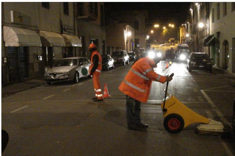
L'area interessata dal tracciato del progetto di massima di TERNA è stata esplorata con il georadar la notte del 3 Novembre 2007. Sono stati rilevati N. 75 moduli di 3x3 metri (dal 1001 al 1075), per un totale di 675 mq. I moduli sono ordinati in una stringa di lunghezza pari a 222 metri, che corre parallela al cordolo del marciapiede ovest della via, ad una distanza di circa due metri da esso.
