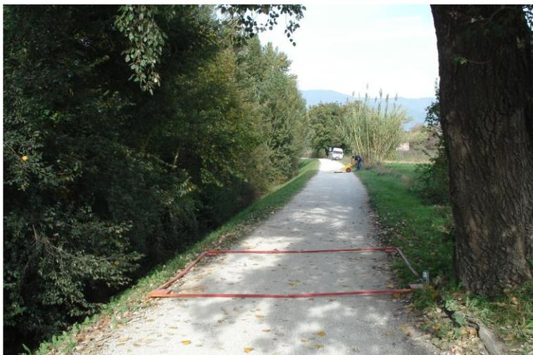
L'area interessata dal tracciato del progetto di massima di TERNA è stata esplorata con il georadar il giorno 17 Ottobre 2007. Sono stati rilevati N. 20 moduli di 3x3 metri (dal 87 al 106), per un totale di 180 mq. I moduli sono allineati in una stringa parallela all'asse della strada vicinale, che non è asfaltata ed è larga circa 3 metri. La lunghezza della stringa è pari a 90 m.
