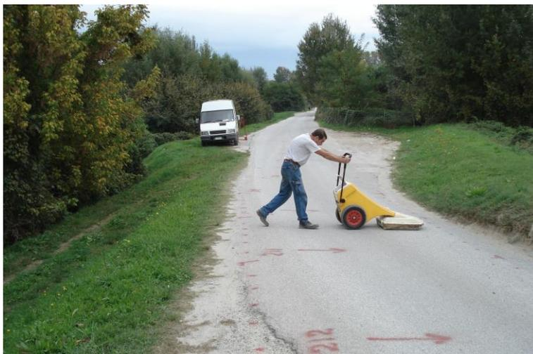
L'area interessata dal tracciato del progetto di massima di TERNA è stata esplorata con il georadar il giorno 18 Ottobre 2007. Sono stati rilevati N. 20 moduli di 3x3 metri (dal 203 al 222), per un totale di 180 mq. I moduli sono allineati in una stringa parallela all'asse della strada vicinale, che in questo tratto monta dal piede esterno dell'argine al suo colmo, è asfaltata ed è larga circa 3 metri, con andamento sinuoso. La lunghezza della stringa rilevata è pari a 60 m.
