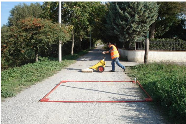
L'area interessata dal tracciato del progetto di massima di TERNA è stata esplorata con il georadar il giorno 17 Ottobre 2007. Sono stati rilevati N. 10 moduli di 3x3 metri (dal 57 al 66), per un totale di 90 mq. I moduli sono allineati in una stringa parallela all'asse della strada vicinale, che non è asfaltata ed è larga circa 3 metri. La lunghezza della stringa è pari a 30 m. La dima rossa in primo piano nell'immagine è esattamente sulla posizione della Buca Giunti G7.
