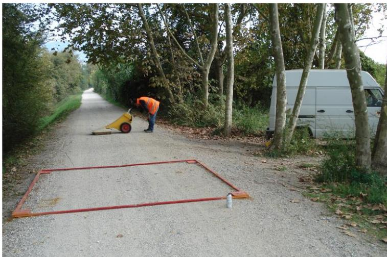
L'area interessata dal tracciato del progetto di massima di TERNA è stata esplorata con il georadar il giorno 18 Ottobre 2007. Sono stati rilevati N. 15 moduli di 3x3 metri (dal 156 al 170), per un totale di 135 mq. I moduli sono allineati in una stringa parallela all'asse della strada vicinale, che non è asfaltata ed è larga circa 3 metri. La lunghezza della stringa è pari a 45 m.
