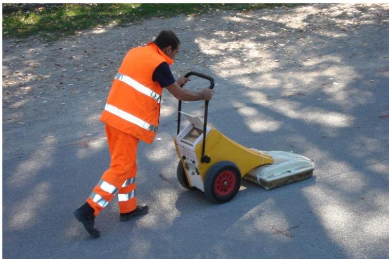
L'area interessata dal tracciato del progetto di massima di TERNA è stata esplorata con il georadar il giorno 19 Ottobre 2007. Sono stati rilevati N. 15 moduli di 3x3 metri (dal 241 al 255), per un totale di 135 mq. I moduli sono allineati in una stringa parallela all'asse della strada vicinale, che in questo tratto è asfaltata ed è larga circa 4,5 metri. La lunghezza della stringa rilevata è pari a 45 m.
