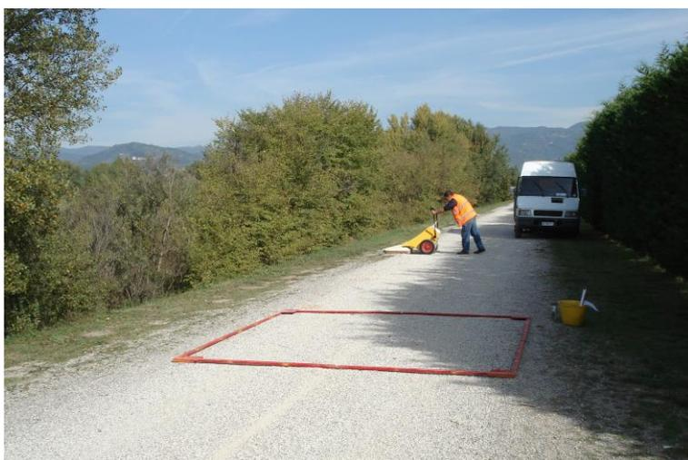
L'area interessata dal tracciato del progetto di massima di TERNA è stata esplorata con il georadar il giorno 17 Ottobre 2007. Sono stati rilevati N. 10 moduli di 3x3 metri (dal 77 al 86), per un totale di 90 mq. I moduli sono allineati in una stringa parallela all'asse della strada vicinale, che non è asfaltata ed è larga circa 3 metri. La lunghezza della stringa è pari a 90 m.
