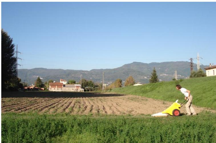
L'area interessata dal tracciato del progetto di massima di TERNA è stata esplorata con il georadar il giorno 16 Ottobre 2007. Sono stati rilevati N. 56 moduli di 3x3 metri (dal 01 al 56), per un totale di 504 mq. I moduli sono allineati in una stringa parallela all'asse della strada golenale, che non è asfaltata ed è larga circa 3 metri. La lunghezza della stringa è pari a 168 m.
