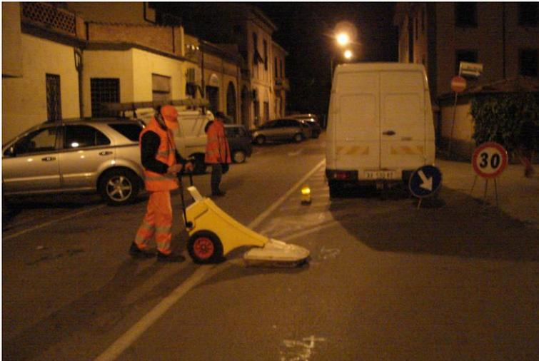
L'area interessata dal tracciato di massima di TERNA è stata esplorata con il georadar la notte del 31 Ottobre 2007. Sono stati rilevati N. 10 moduli 3x3 metri (dal 536 al 545), per un totale di 90 mq. I moduli sono ordinati in due stringhe lineari da tre e in un gruppo quadrato di lato pari a 6 metri. Ciò allo scopo di coprire l'area della confluenza di Via San Marco con la S.S.12 dell'Abetone.
