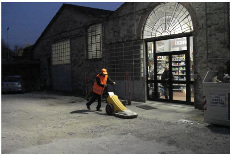
L'area interessata dal progetto di massima di TERNA è stata esplorata con il georadar la sera del 6 Novembre 2007. Sono stati rilevati N. 11 moduli da 3x3 metri (dal 1201 al 1211), per un totale di 99 mq. I moduli sono ordinati in una stringa che contiene il tracciato di massima del cavo, ed è lunga 33 metri.
