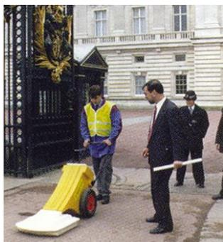
PipeHawk è un georadar terrestre dotato di software specializzato per rilevamento di oggetti lineari di diametro compreso tra 18mm e 150/200cm. PipeHawk ha dimensioni e forma simili a quelle di un grosso tagliaerba. Si tratta di una robusta macchina di concezione militare, senza cavi o altri componenti delicati esposti, adatta ad essere impiegata anche in condizioni di tempo avverso.
